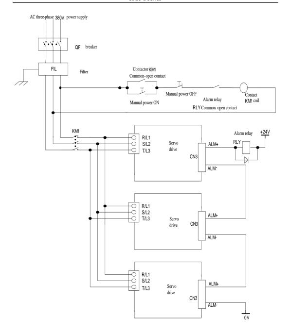
Fig 4.3.14 380V multiple online wiring
